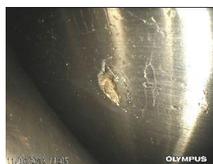
Obr. 3: V jasném světle Adaptivní osvětlení zvyšuje pravděpodobnost detekce vad v tmavých oblastech.
